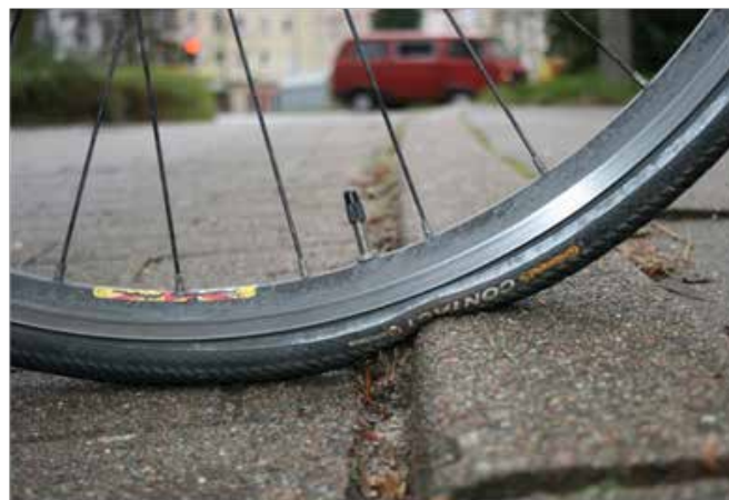
62. attēls - Betona apmales (pat ar apaļu malu) iedarbība uz riepu (Hamburga, Vācija)
